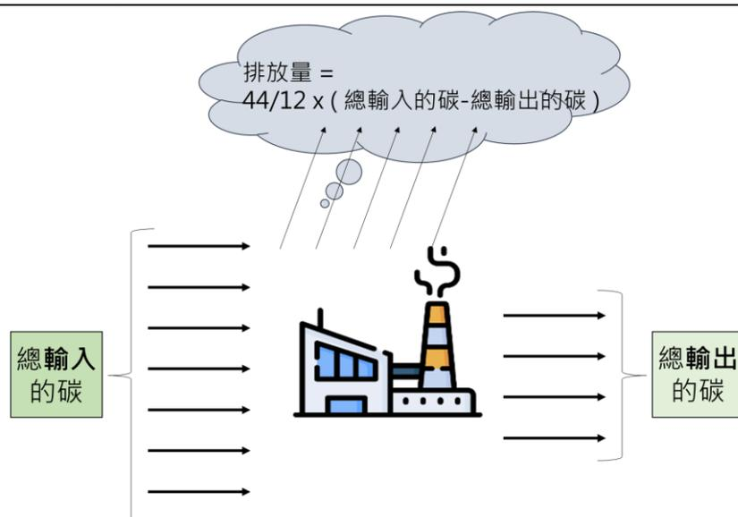
圖 2-5、質量平衡法計算示意圖
