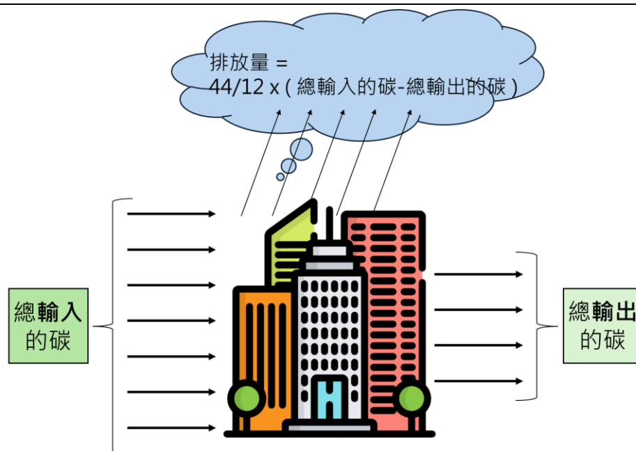
圖 2-18、質量平衡法計算示意圖
